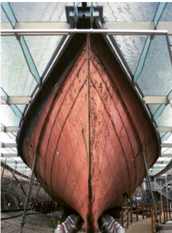
S/S Great Britain on nykyään museolaivana. Jotta alus ei ruostuisi enempää, on sen vesirajan alapuolinen runko eristetty lasilevyillä ulkomailmasta, ja kosteudenpoistajat pitävät kosteuden mahdollisimman alhaisena.
