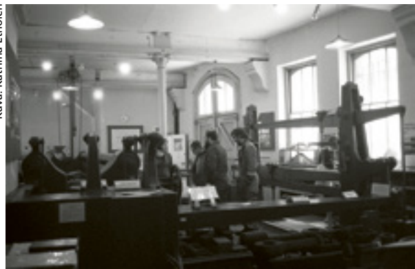
David Kirkaldyn suunnittelema 14,5 metrin pituinen Universal Testing Machine valtaa katutasen kerroksen kokonaan.
